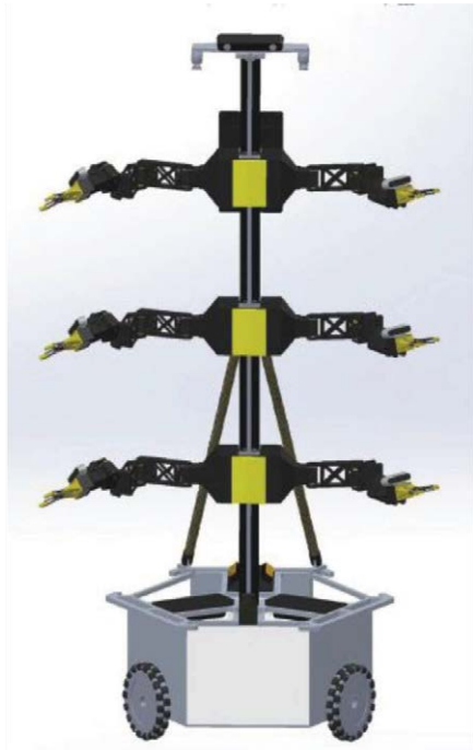
13. kép: A Nyugat-virginiai Egyetem StickBugja, amely üvegházi és függőleges gazdaságok beporzására is használható
